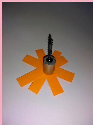
**Paso 4:** Colocamos la pila en la punta del tornillo, esta se va a atraer ya que el tornillo está magnetizado.
